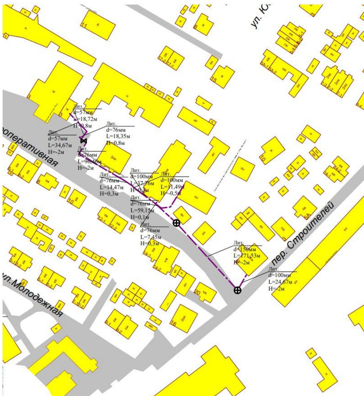
Рисунок 1.3.2.1 - Схема расположения тепловой сети котельной СДК п.
