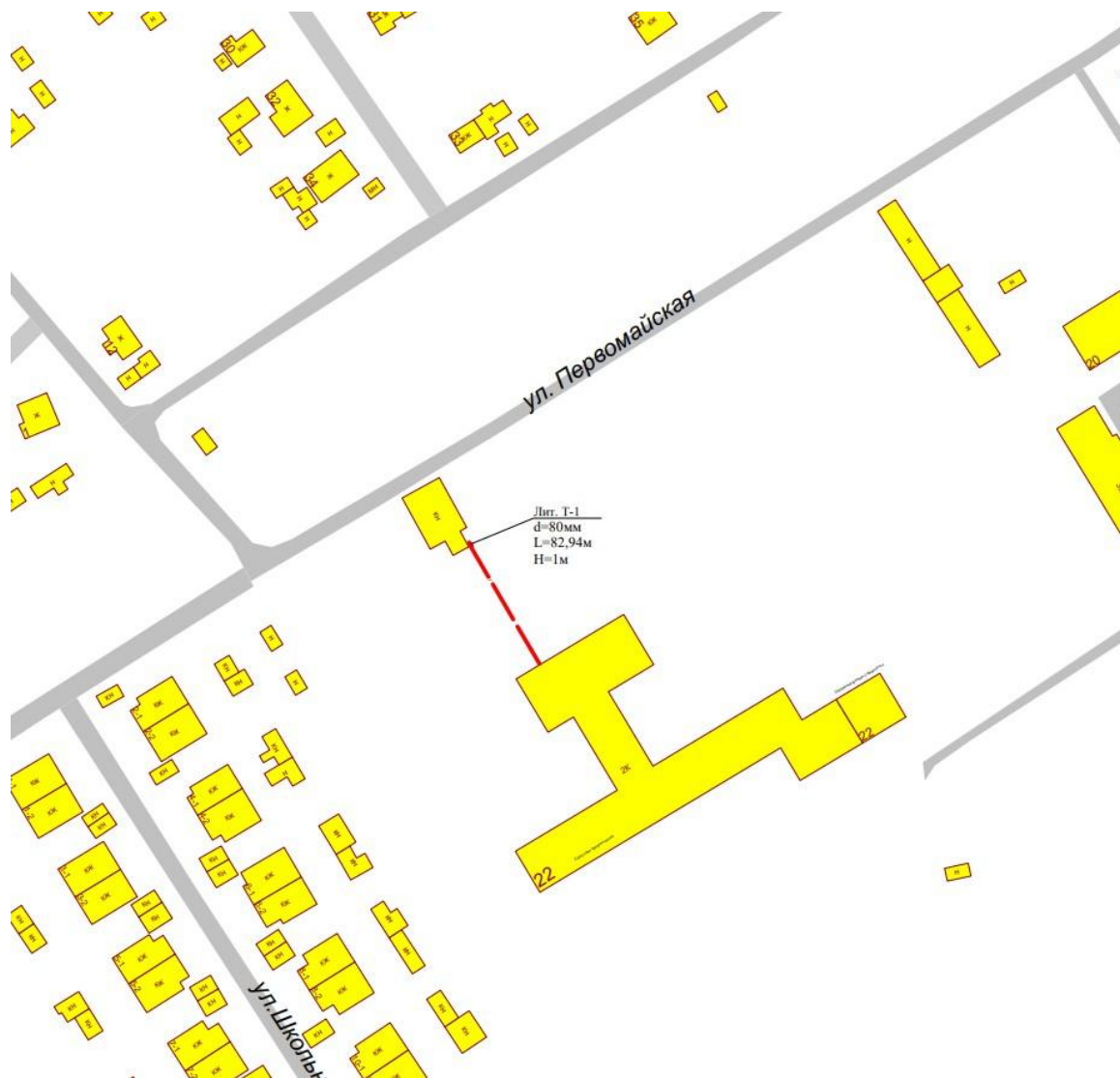
Рисунок 1.3.2.4 - Схема расположения тепловой сети котельной СОШ п.
